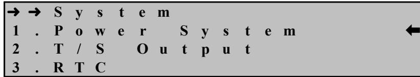
(3) 우(→)방향 Key 누름 : Setting ▶ System ▶ Power System 화면 표시
