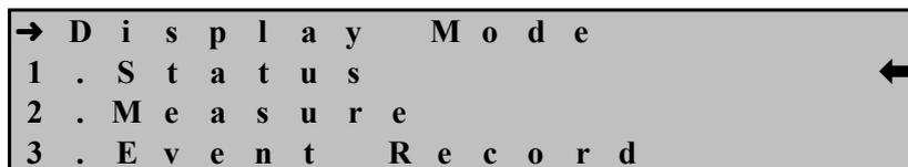
상태 표시화면 (Status Mode)으로 전환하기 위해서는 커서 (←)가 위치한 상태에서 우(→)방향 Key를 누르면 아래와 같은 세부적인 상태 표시 항목으로 이동합니다.
