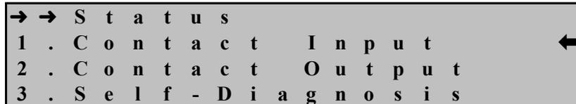
(3) 우(→)방향 Key 누름 : Display ▶ Status ▶ Contact Input 화면 표시
