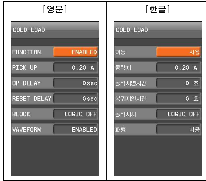
<Figure. COLD LOAD(CLP) 설정 화면>
