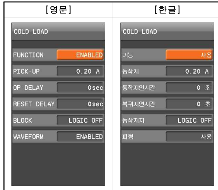
<Figure. COLD LOAD(CLP) 설정 화면>
